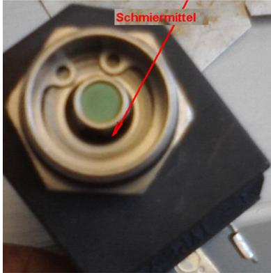
Если якорь втягивающего магнита передвигается туго (переключать для проверки в демонтированном состоянии) (→ рисунок 65), то в кольцевую щель можно подать немного распыленного масла (→ рисунок 65).
